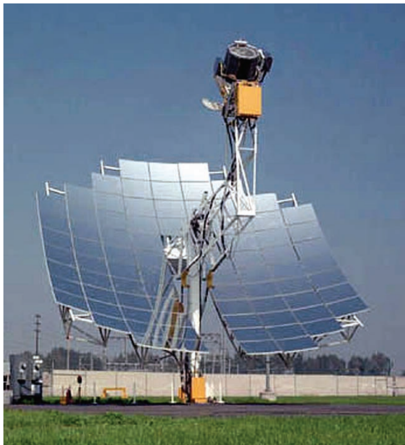
Ενεργειακό Ηλιακό Σύστημα Κατόπτρου-κινητήρα Stirling
